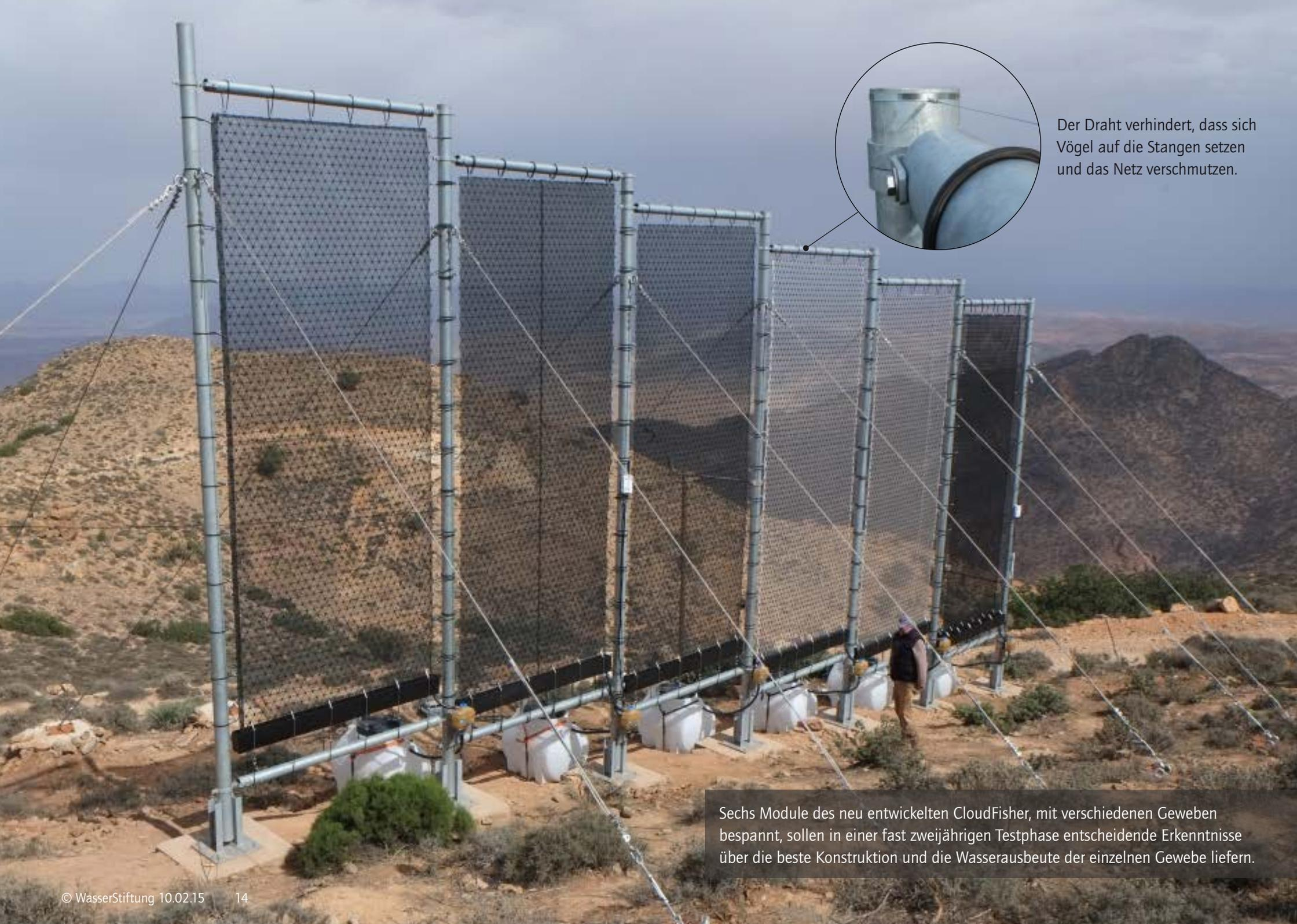
Der Draht verhindert, dass sich Vögel auf die Stangen setzen und das Netz verschmutzen.
